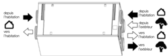
CONFIGURATION INVERSÉE ARRIÈRE HORIZONTAL
